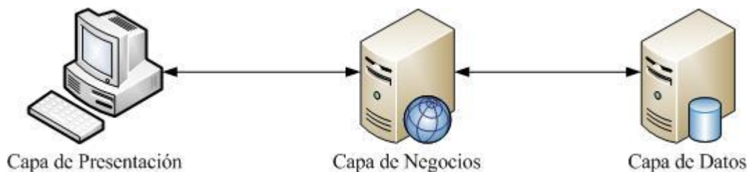
Figura 13. Arquitectura de la programación en capas.
