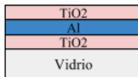
Figura 10: Representación esquemática de filtro de baja emisividad (TiO 2 /Al/TiO 2 ).
