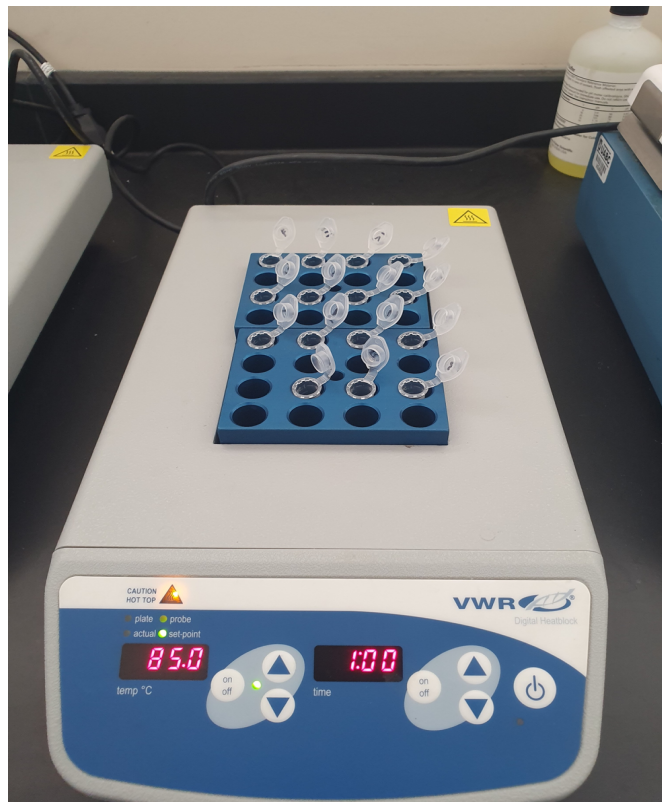
Figura 9. Thermo block. Evaporación de agua bidestilada de los tubos a 85°C
