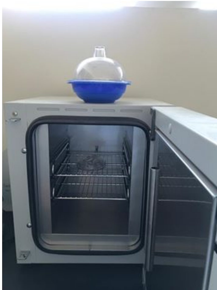
Figura 10. Eliminación de Humedad. Tubos en caja petri dentro del Horno
