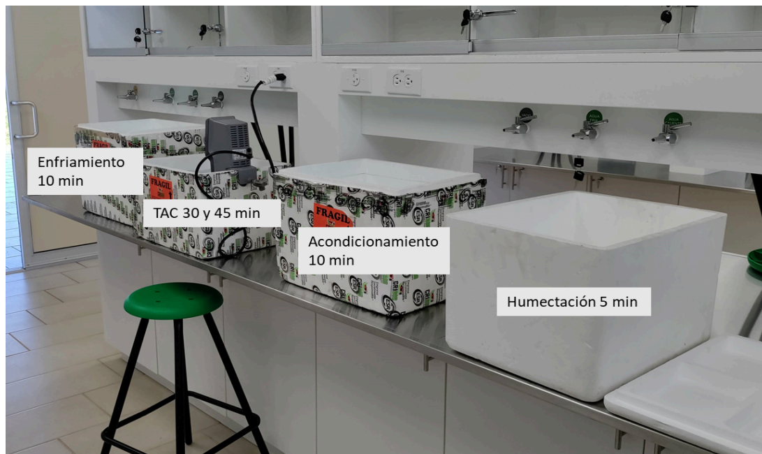
Figura 5. Sistema experimental utilizado para la aplicación del tratamiento con agua caliente (TAC) en esquejes de vid.
