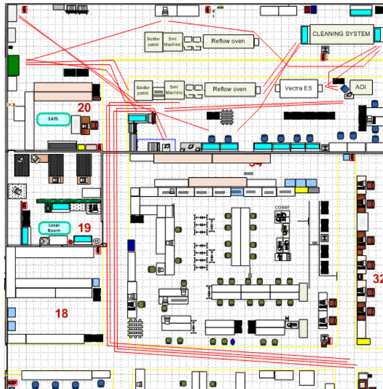
Diagrama 2. Diagrama de recorridos. Fuente: Departamento de Ingeniería Industrial, Electro Ópticas Superior.
