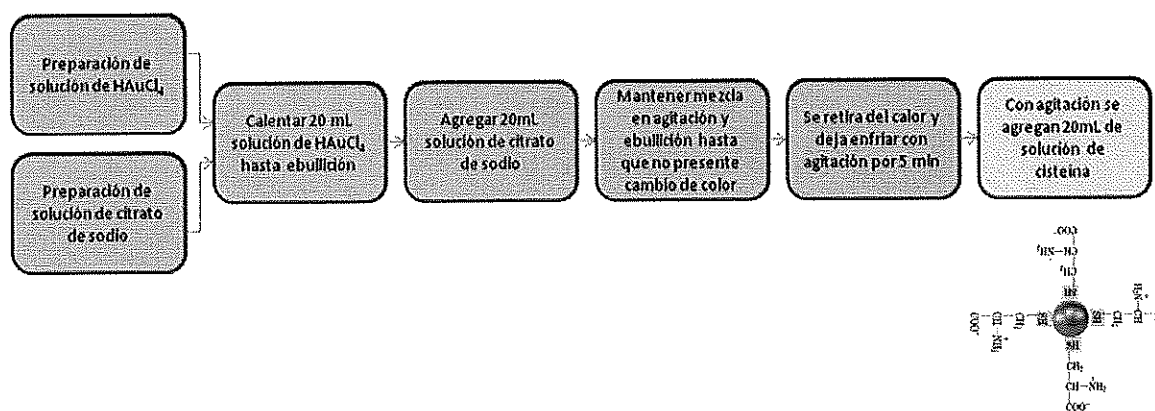
Figura 15. Esquema de funcionalización de AuNPs con cisteína.
