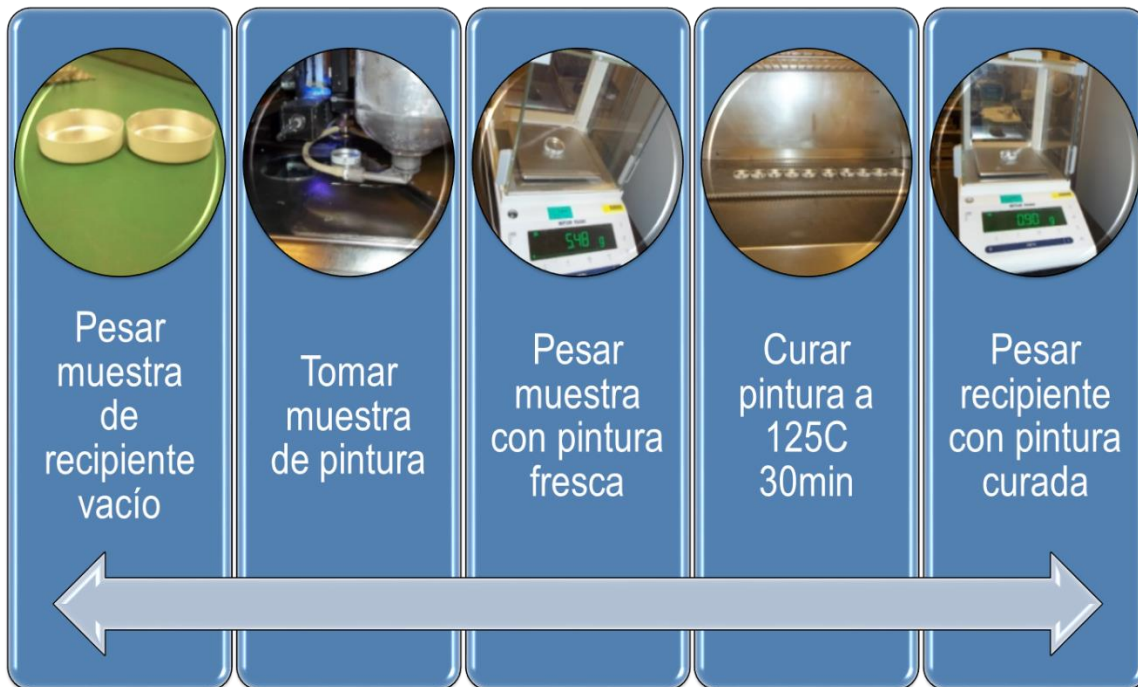
Fig. 2.1.3e. Método para medir sólidos en la pintura
