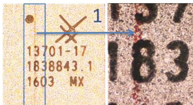
Fig. 2.6a Raya vertical de lado a lado, solo dañando la última capa de titanio
