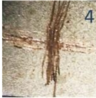
Fig. 2.6d Rayones los cuales exponen parcialmente el moldeo
