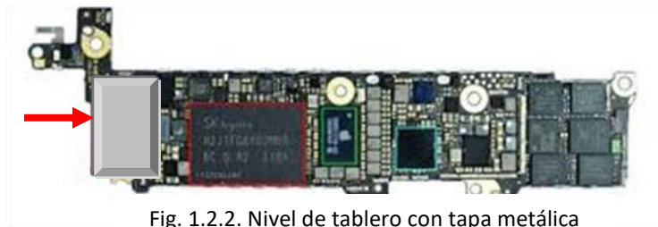
Fig. 1.2.2. Nivel de tablero con tapa metálica
