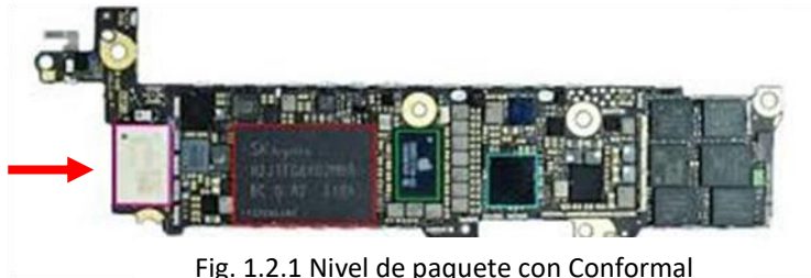
Fig. 1.2.1 Nivel de paquete con Conformal
