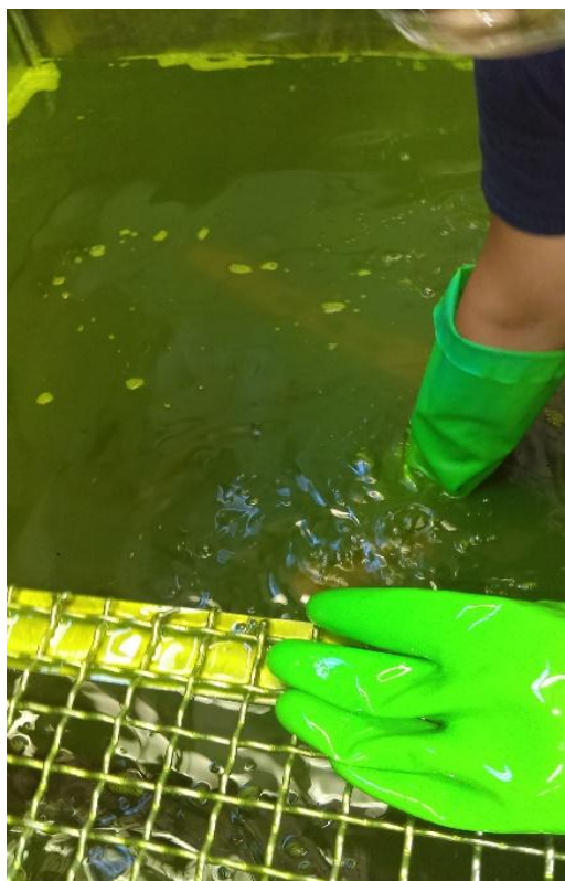
Figura 2.2 Aplicación de líquido penetrante.
