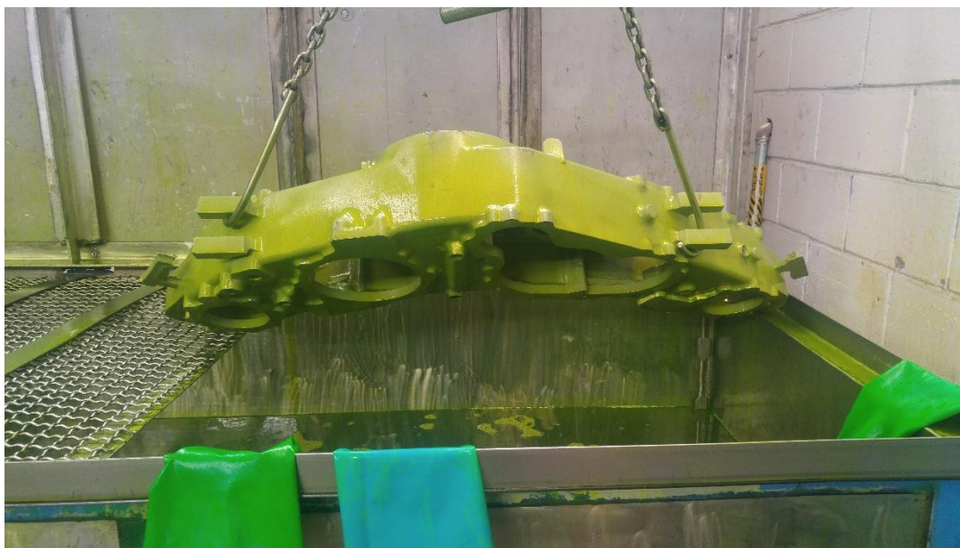
Figura 2.3 Aplicación de líquido penetrante por inmersión.
