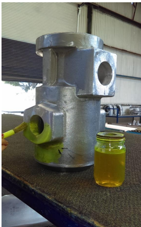
Figura 2.4 Aplicación del penetrante por brocha.
