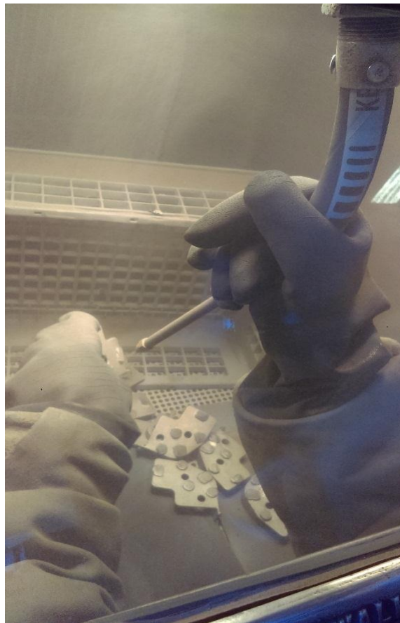
Figura 2.1 Limpieza mecánica por aplicación de arena seca a presión.
