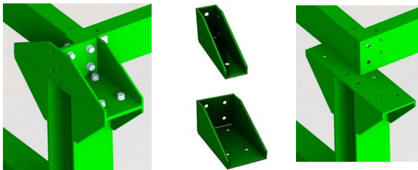
Figura 58. Colocación de abrazaderas en las esquinas de los módulos
