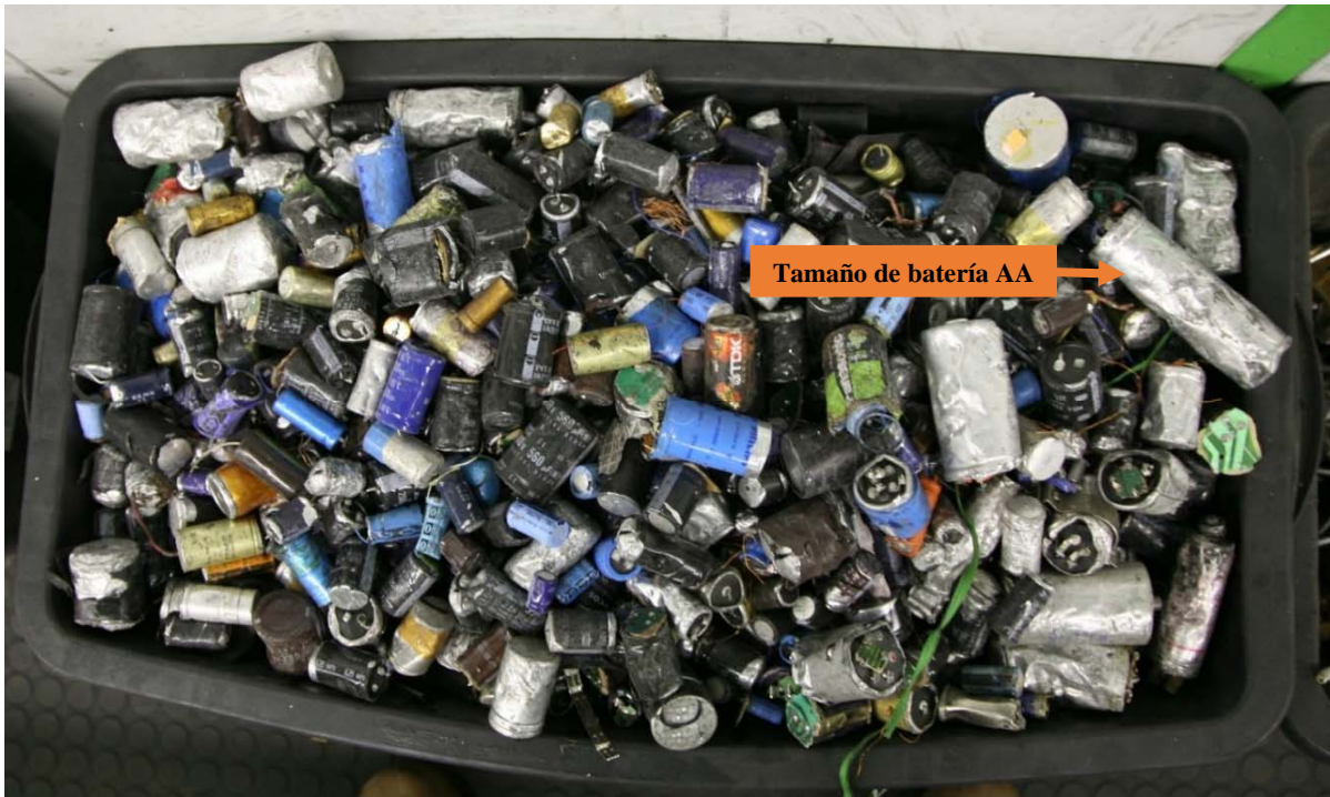
Figura 23. Materiales peligrosos separados durante el proceso de reciclaje
