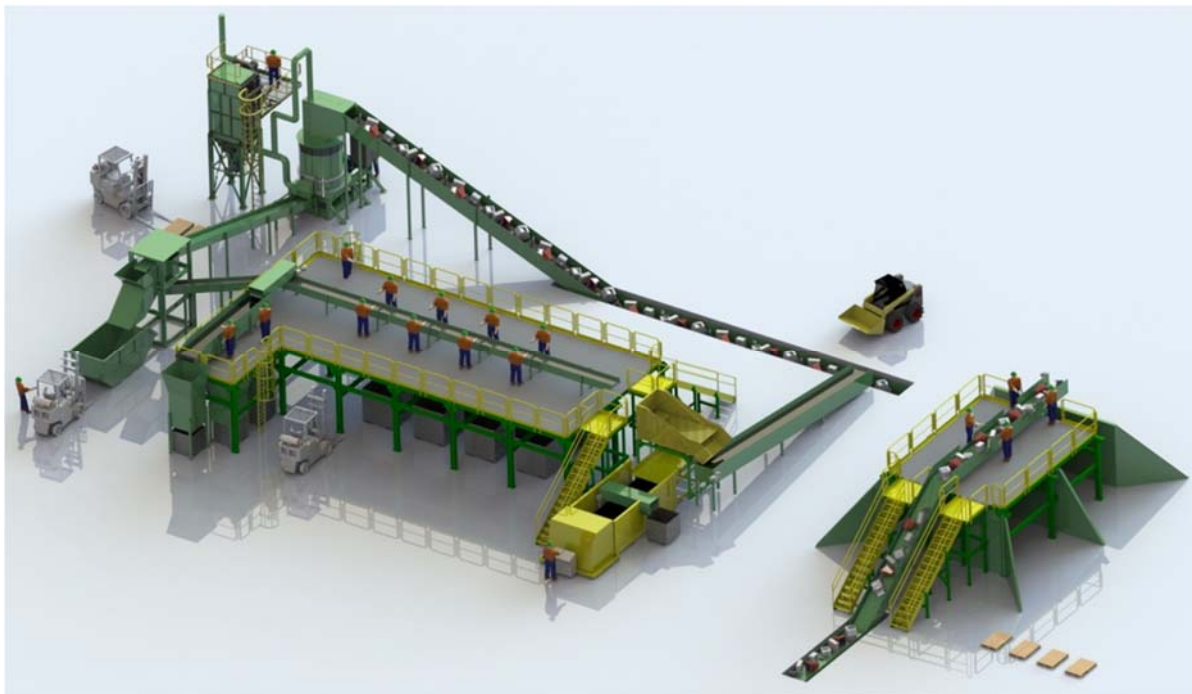
Figura 77. Integración de mezzanines al proceso diseñado
