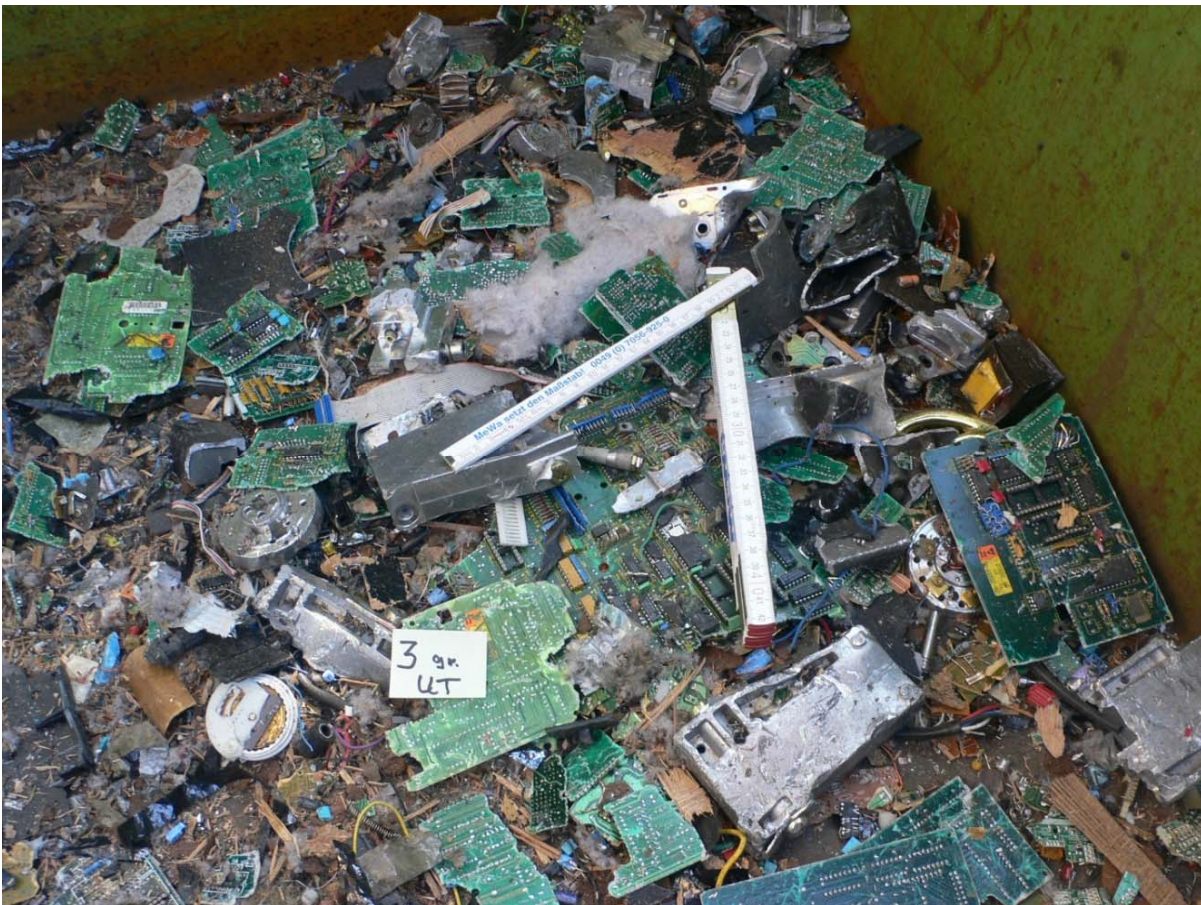
Figura 24. Residuos después de la fragmentación con la máquina de impacto por cadenas
