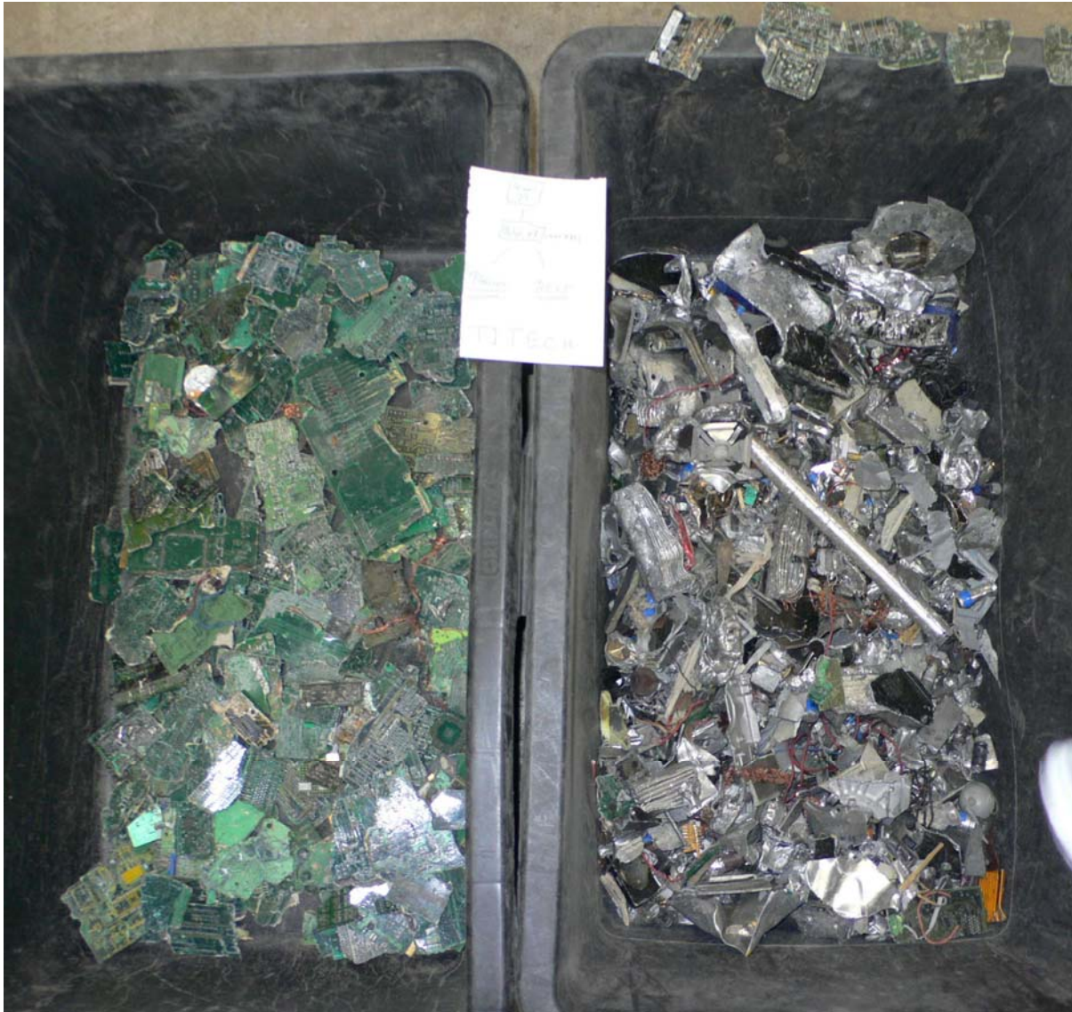
Figura 25. Materiales separados en operaciones posteriores a la máquina de impacto
