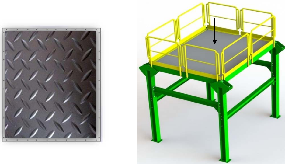
Figura 61. Piso de diamante para los módulos
