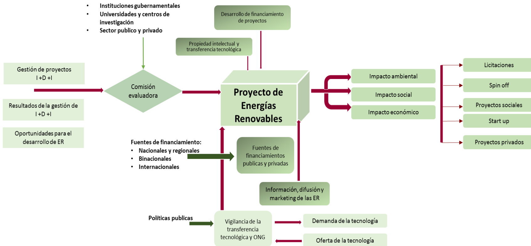
Figura 33. Modelo del desarrollo para proyectos de energías renovables y factores involucrados para su transferencia tecnológica
