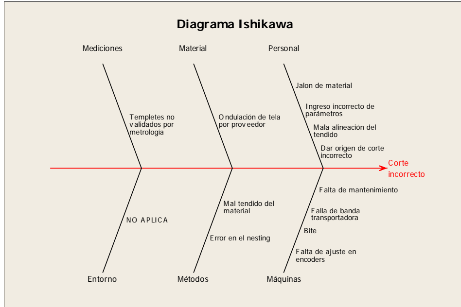
Figura 3: Posibles causas que provoquen los defectos significativos en los paneles principales.
