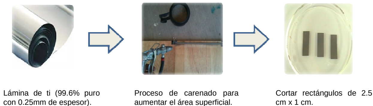
Figura 3.1. Preparación del sustrato de titanio.
