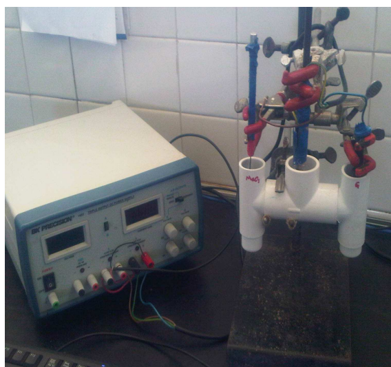
Figura 6.33. Celda electroquímica de PVC con tres electrodos.
