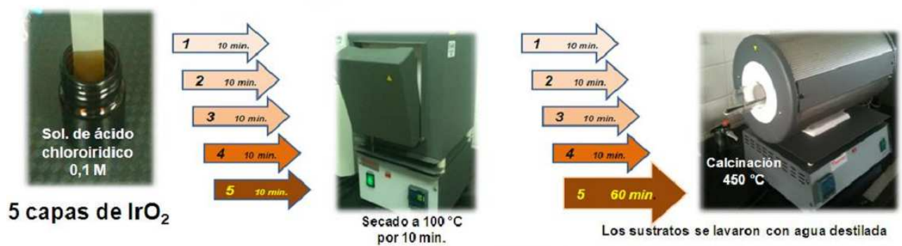
Figura 3.3. Depósito de capa de \text{IrO}_2/\text{Ti} .
