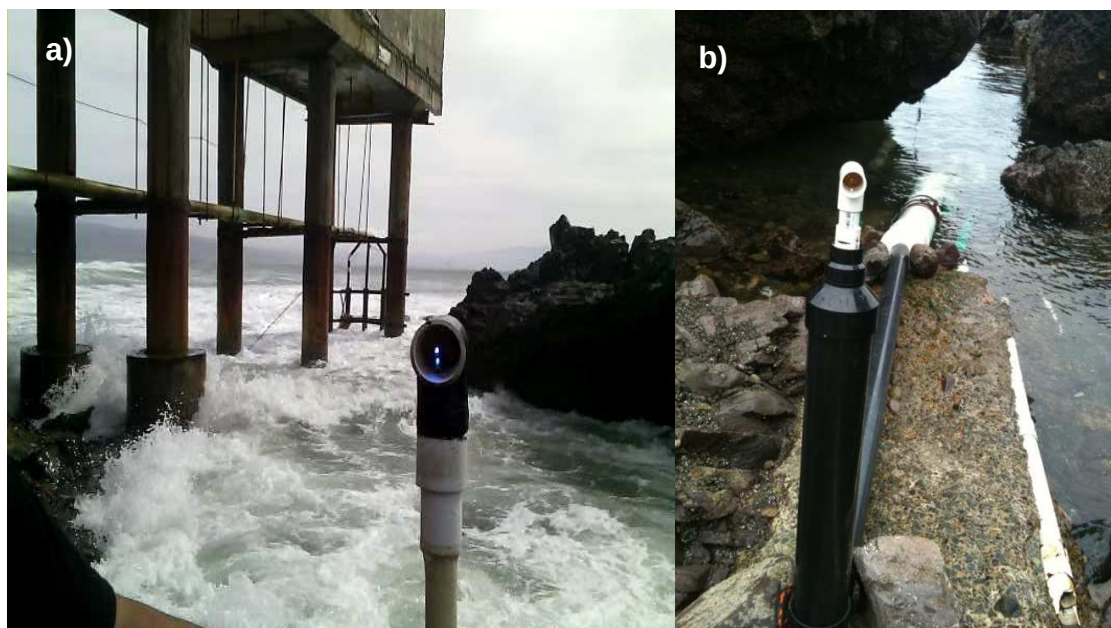
Figura 5.3. Segundo prototipo de columna oscilante de agua comprobando su funcionamiento en ambos casos, en condiciones de a) marea alta y oleaje, b) marea muy baja y sin oleaje.
