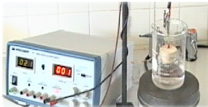
Figura 3.4. Proceso de anodizado de los electrodos a 0.5 M \text{H}_2\text{SO}_4 .
