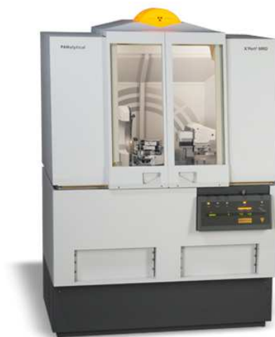
Figura 4.10. Difractómetro de rayos X Philips X'pert [37].
