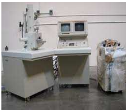
Figura 4.6. Microscopio electrónico de barrido JEOL JSM 5300 [33].
