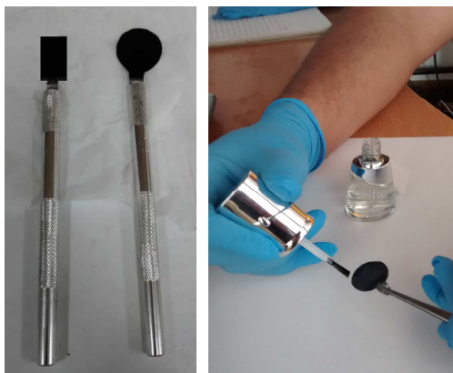
Figura 3.9. Electrodos después del proceso de electrodeposición.
