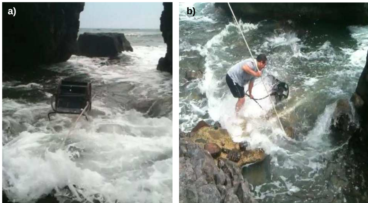
Figura 5.2. Primer prototipo de generador por medio de la fuerza de la ola.
