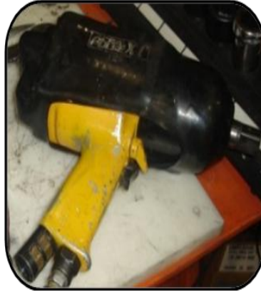
1.12.- Herramienta neumática de torque controlado con unidad de pulso.
