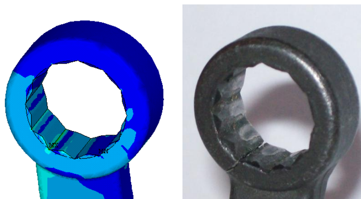
Figura 3.5.- Comparativo entre zona de esfuerzo máximo de análisis y fractura en llave.
