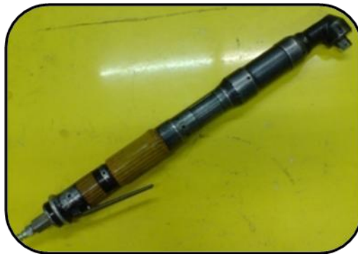
1.11.- Herramienta de torque neumática con transmisión de engranes “boa”.
