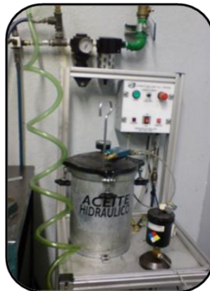
1.13.- Sistema de vacío para mantenimiento a unidad de pulso.
