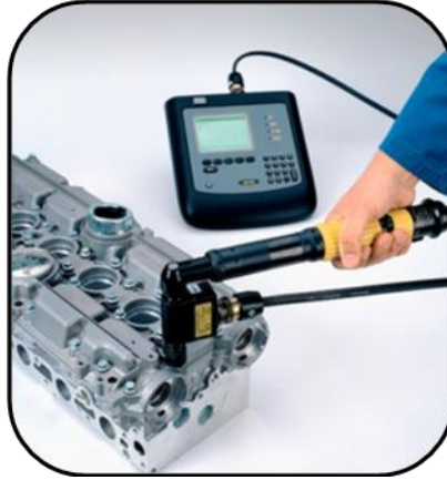
1.19.- Sistema transductor y módulo digital para calibración de dtool.
