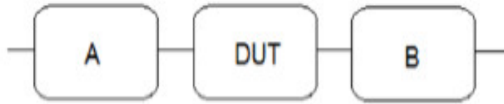
Fig.2.33 Configuración cascada de los conectores y dispositivo.
