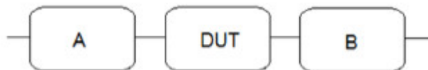
Fig.A.1 configuración cascada de los conectores de entrada y salida al dispositivo.
