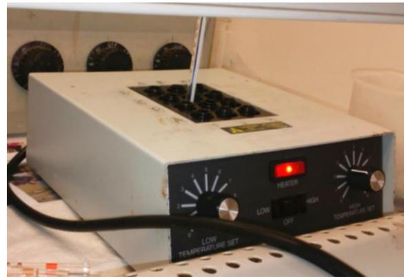
Figura 8. Thermo block para evaporar el solvente de extracción de lípidos.
