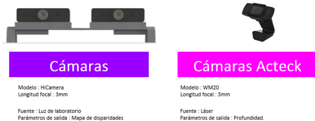
Ilustración 23. Características técnicas de las cámaras utilizadas para el cálculo de la profundidad.
