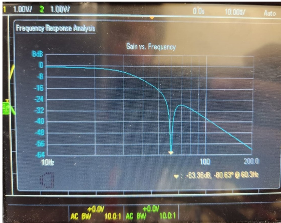
Figura 7.4: Gráfica de la respuesta en frecuencia de la señal de salida de la etapa de filtrado con filtros notch.
