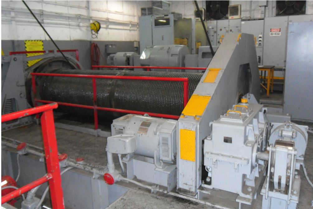
Figura 21. Motor del sistema de Boom.
