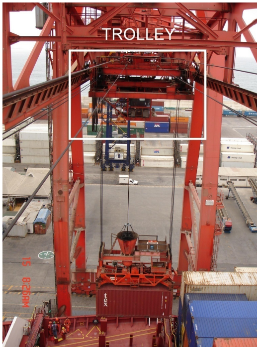
Figura 2. Trolley de la grúa pórtico en operación.
