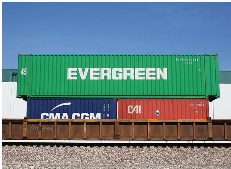
Figura 9. Contenedor Dry Van de 20 y 45 pies.
