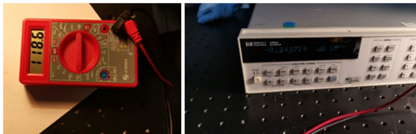
Figura (16). Multímetros utilizados para la medición de voltaje y corriente.
