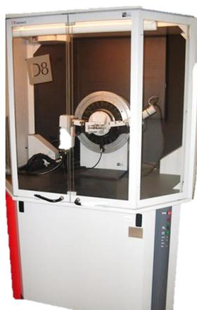
**Figura 23.** Difractómetro de rayos-X de polvos DRX BRUKER D8 ADVANCE.
