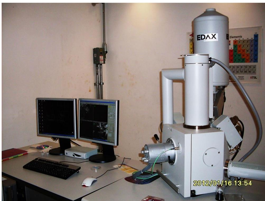
**Figura 24.** Microscopio electrónico de barrido ESEM FEI QUANTA 200.
