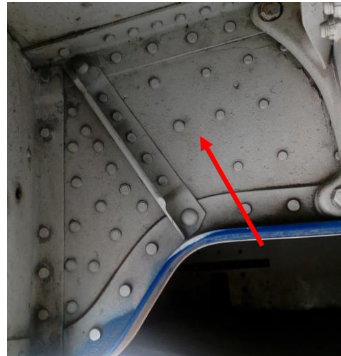
Imagen 36. Segunda placa de aluminio que conforma la Web
