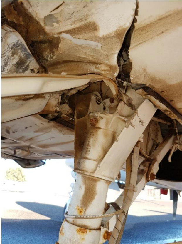
Imagen 40. Estructura alar alrededor del patín
