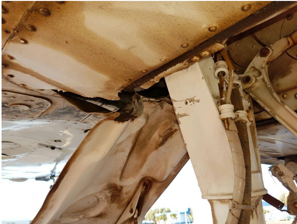
Imagen 41. Parte de la compuerta del tren de aterrizaje y piel del ala dañadas por la ruptura de la Web y el desplazamiento del patín hacia esta zona
