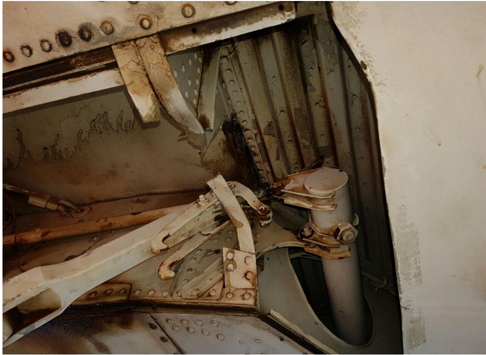
Imagen 38. Ruptura total de la Web de soporte para el tren de aterrizaje
