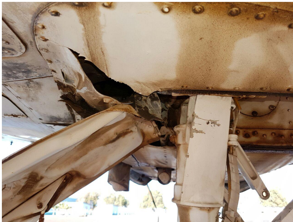
Imagen 37. Estructura alar inferior dañada por falla
