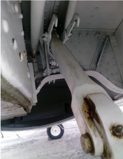
Imagen 33. Tren de aterrizaje sujetado a la Web
