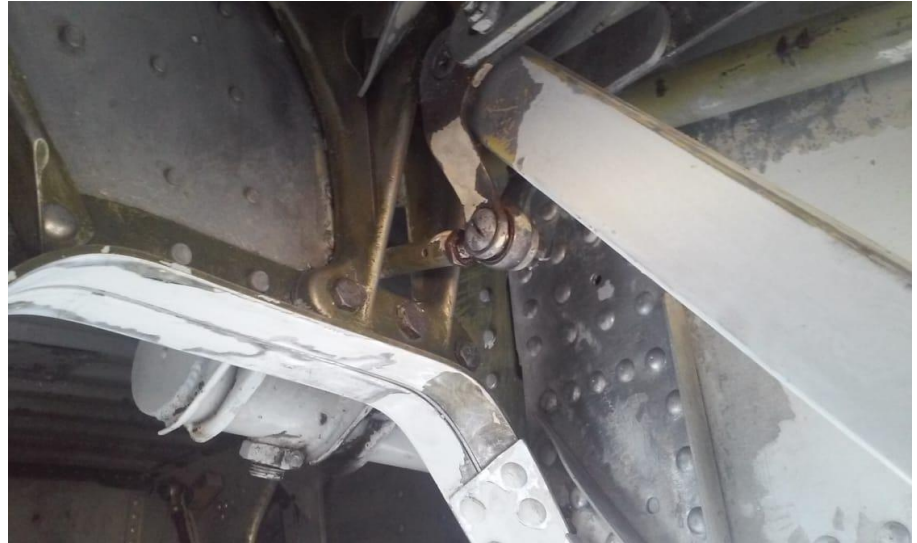
Imagen 34. Herraje del tren de aterrizaje sujetado a la Web
