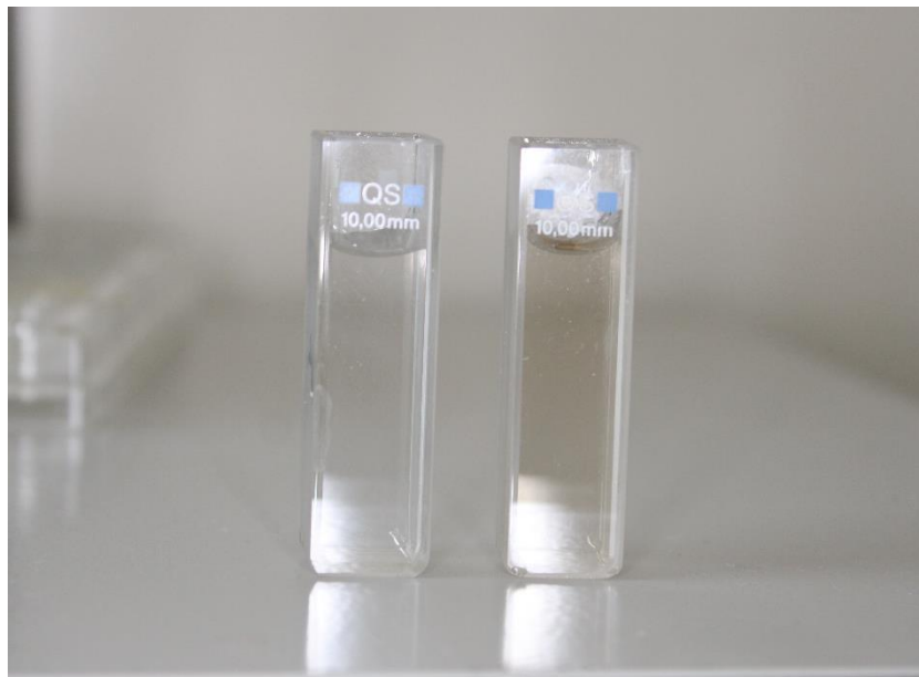
Figura 4. Celdas de cuarzo utilizadas para la caracterización. A la izquierda celda con agua destilada, a la derecha celda con solución de AgNP
