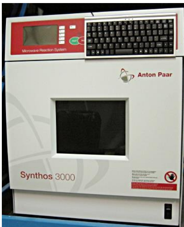
Figura 5. Sistema de reacción de microondas, Anton Paar Synthos 3000 .
