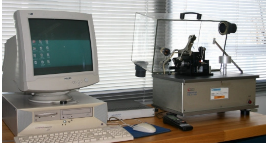
Figura 3.25 Aparato de prueba de tribología
