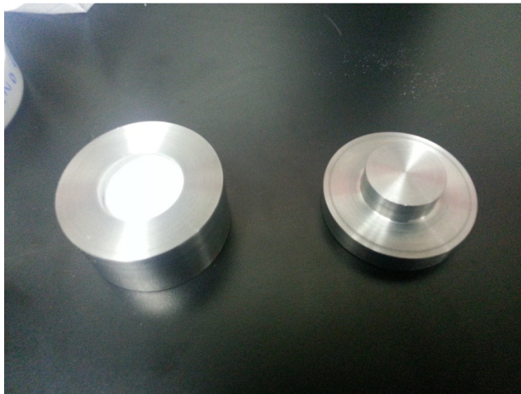
Figura 3.9. Molde llenado con UHMW-PE
