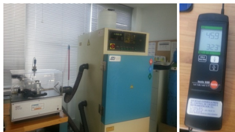
Figura 3.24. Equipo de control de humedad y temperatura y equipo de monitoreo
