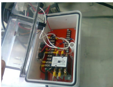
Imagen 3.5 Controlador de temperatura XMTG-808 para la chaqueta de calentamiento.
