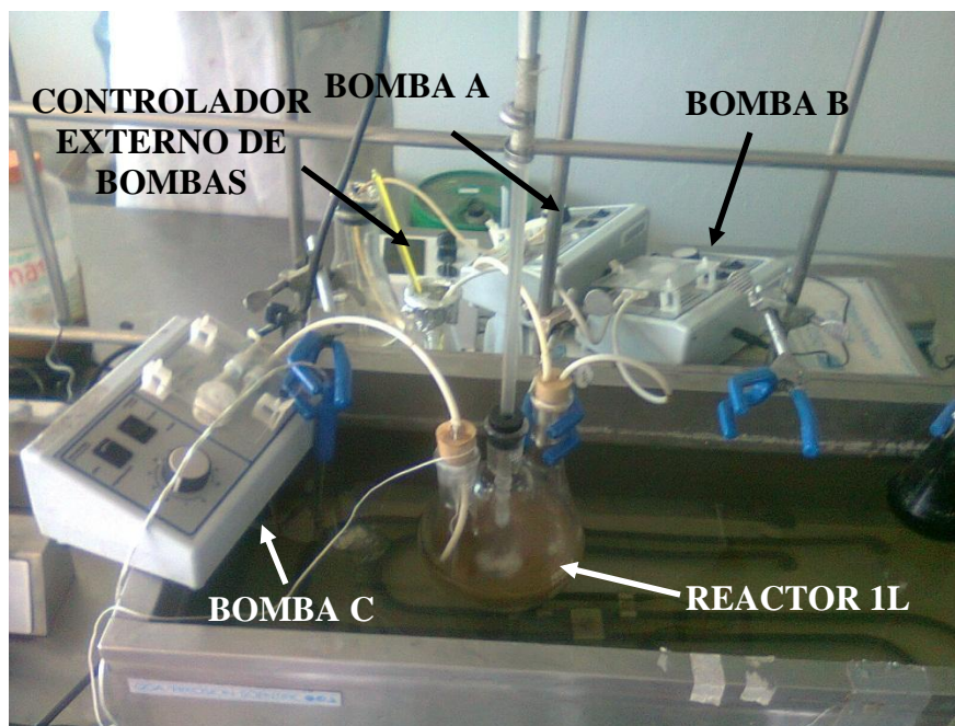
Imagen 3.6 Distribución de bombas en el proceso de esterificación en continuo
