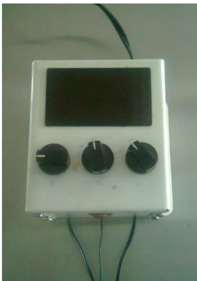
Imagen 3.7 Controlador externo de bombas
