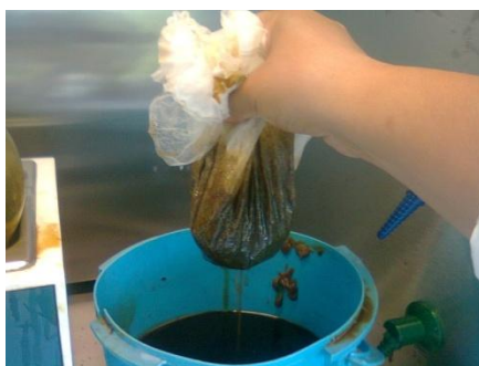
Imagen 3.1 Filtración de los desechos de trampa de grasa
