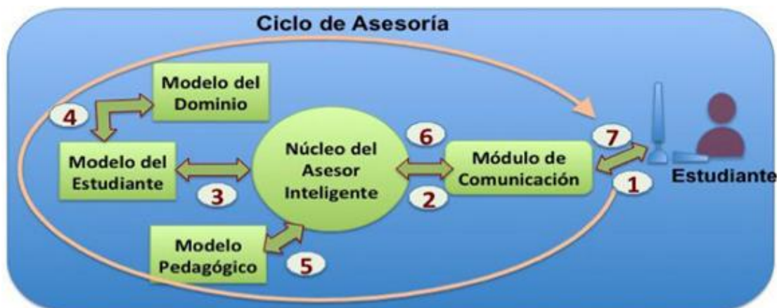
Figura 2.1. Proceso del ciclo de asesoría del ITS: (1) captura la actividad del estudiante; (2) procesa los datos de entrada; (3) actualiza el modelo cognitivo del estudiante; (4) evalúa el desempeño del estudiante; (5) define la acción de asesoría a ofrecer; (6) selecciona el esquema de comunicación; y (7), proporciona retroalimentación al estudiante.
