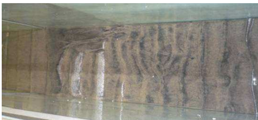
Figura 29 Resultados experimentales en la formación de Ondulitas, para el experimento p3030. Vista superior.
