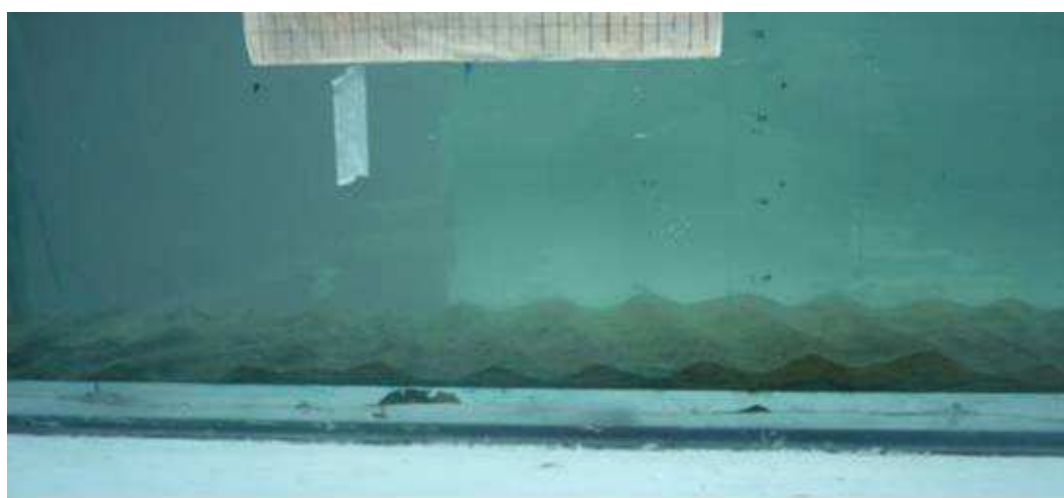
Figura 27 Resultados experimentales en la formación de Ondulitas, para el experimento r3040.
