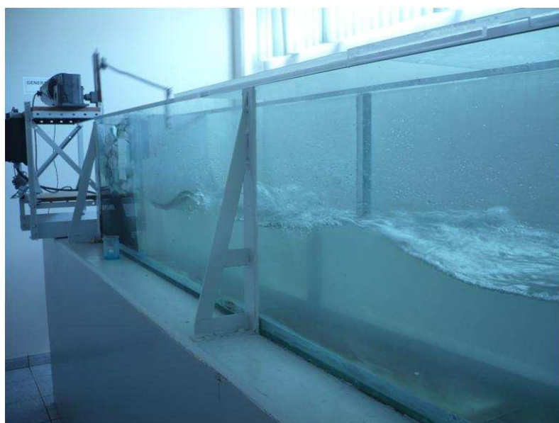
Figura 14 Canal de olas en el laboratorio de Fluidos Geofísicos.
