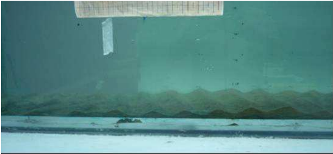
Figura 28 Resultados experimentales en la formación de Ondulitas, para el experimento p3020.
