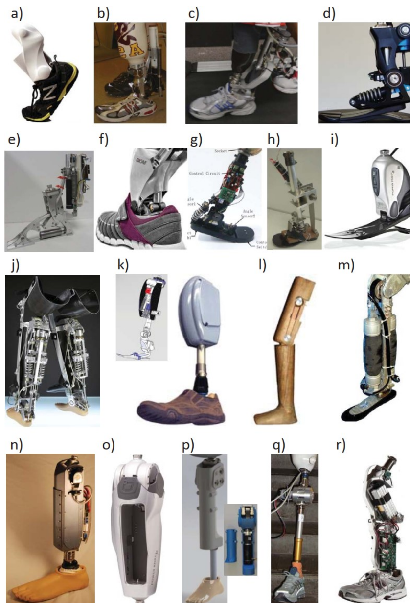
Figura 1.7: Prótesis activas para tobillo (a-j), rodilla (k-q) y ambas (r). Tomada de (Grimmer and Seyfarth, 2014).
