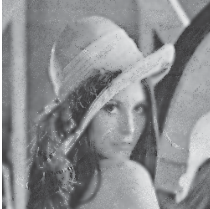
Figura 47. Resultado de aplicar el filtro tipo sigma con caja adaptable 5x5 a la imagen de Lena con ruido Poisson.
