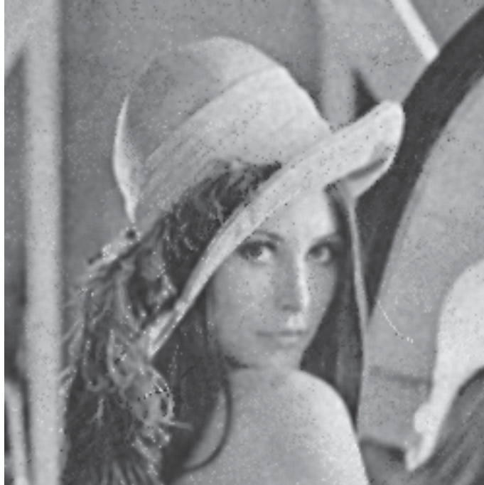
Figura 46. Resultado de aplicar el filtro tipo sigma con caja adaptable 3x3 a la imagen de Lena con ruido Poisson.
