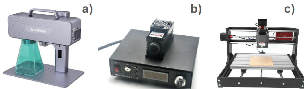
Figura 12: a) Láser IR, b) Láser UV, c) CNC con láser visible (450nm- azul) utilizados para la carbonización láser
