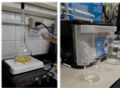
Figura 11. recuperación de solvente mediante destilación
