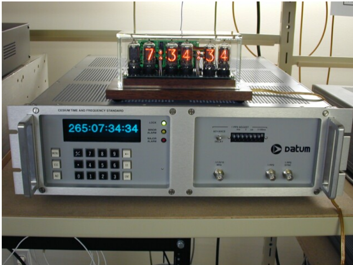
Figura 1.20. Oscilador de cesio.
