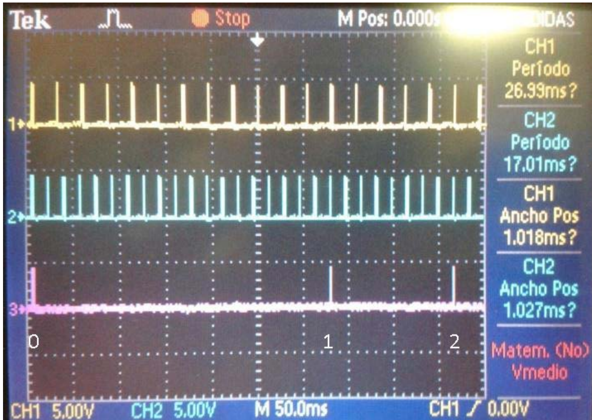
Figura 5.7. Experimento de coincidencia de pulsos con T_0=17\text{ms} , T_x=27\text{ms} , \tau=1\text{ms} \phi=8\text{ms} .
