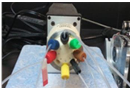
Figura 14. Sistema de inyección: volumen de muestra muy preciso y reproducible. (Laboratorio de Análisis de Agua FCQI UABC 2016)
