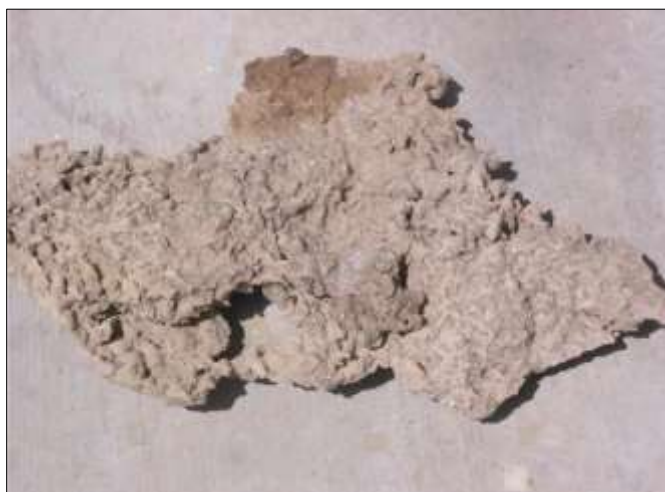
Ilustración 8. Muestra de incrustación mineral típica de cerro prieto. (Valdez, 2013)
