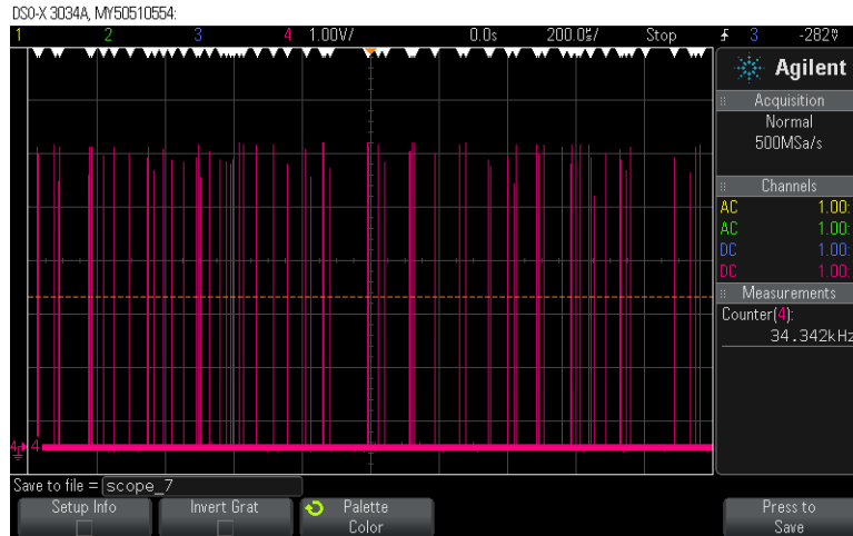
Figura 2.6.: Salida del contador de fotones. Se observan los conteos en una ventana de tiempo.
