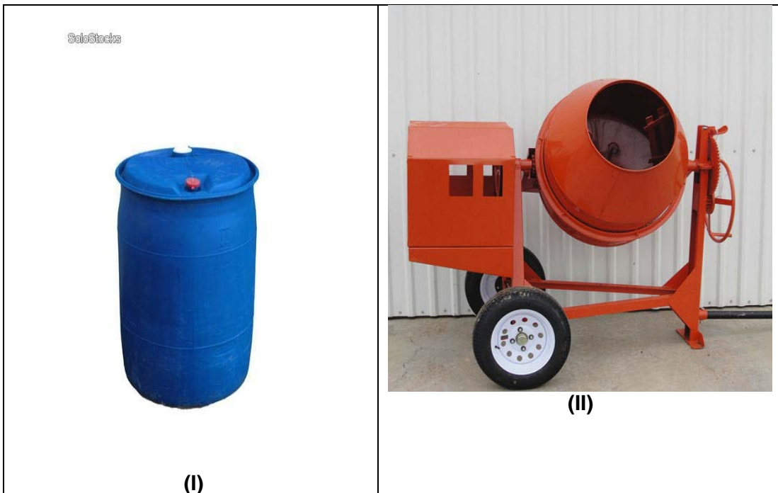
Fotografía 2.- (I) Bote de capacidad de 200 L; (II) Revolvedora con capacidad de 50kg
