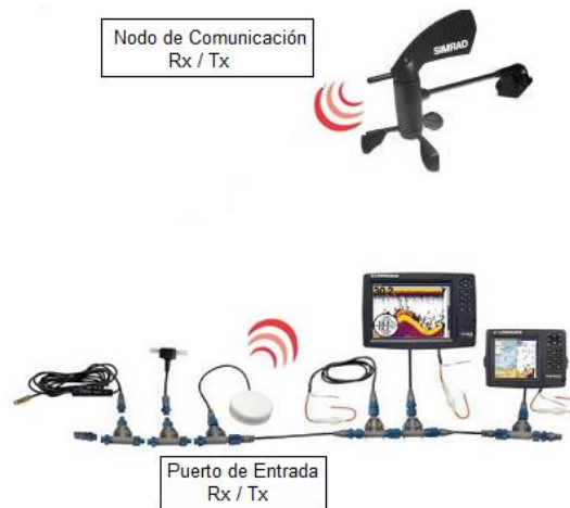
Figura 9. Diagrama de un sistema comunicación inalámbrico punto a punto
