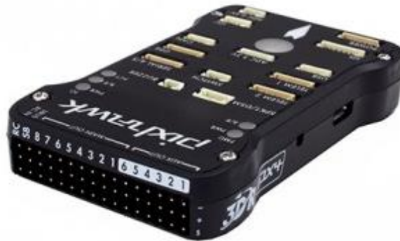
Figura 1.16) Controlador de vuelo con sensores integrados y puertos IO. [28]
