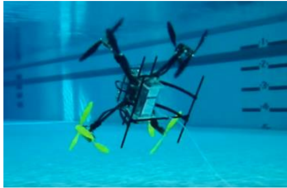
Figura 1.35) Dron híbrido viajando bajo el agua controlado alambreadamente. [62]
