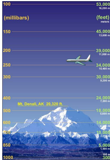
Figura 1.8) Altitud medida a través de la presión atmosférica. [16]
