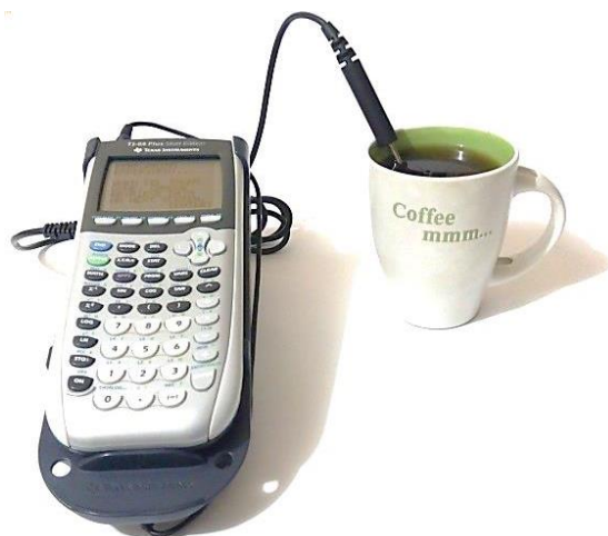
Figura 9. El conjunto de interfaz, calculadora y sensor de temperatura durante la ejecución del primer instrumento de la estrategia didáctica.(Elaboración propia)
