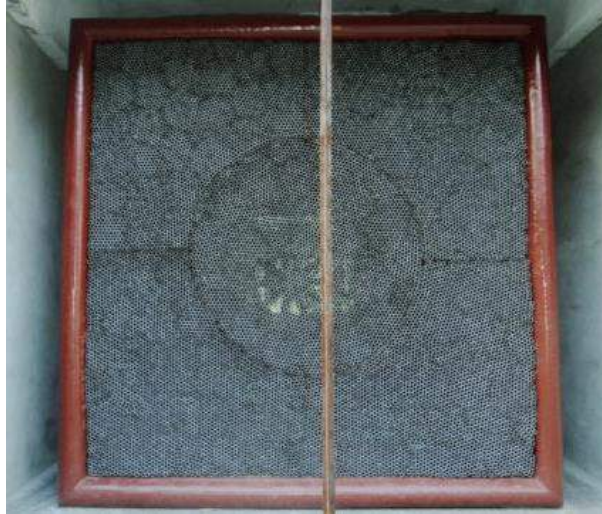
Figura 13. Honeycomb instalado en la entrada del túnel de viento.
