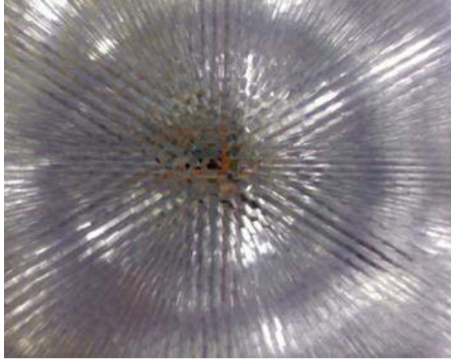
Figura 10. Honeycomb instalado en cámara estabilizadora.
