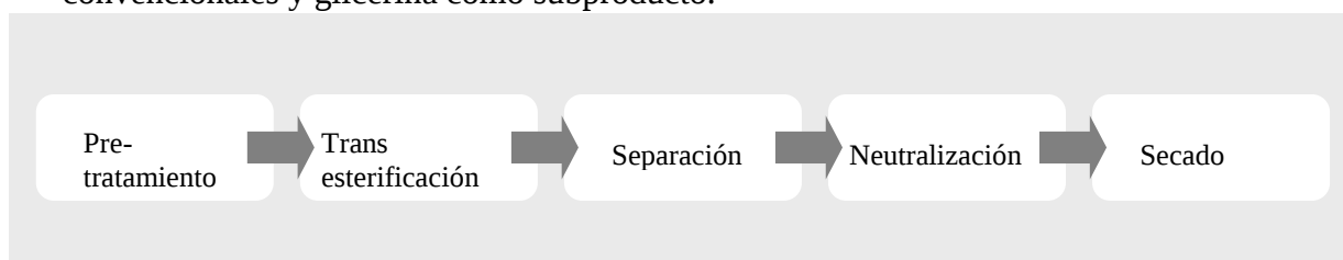
Figura 7. Esquema general del proceso de obtención de biodiesel
