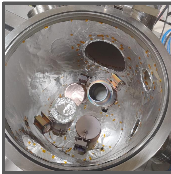
Figura 3.1. Cámara del equipo de sputtering recubierta de aluminio.
