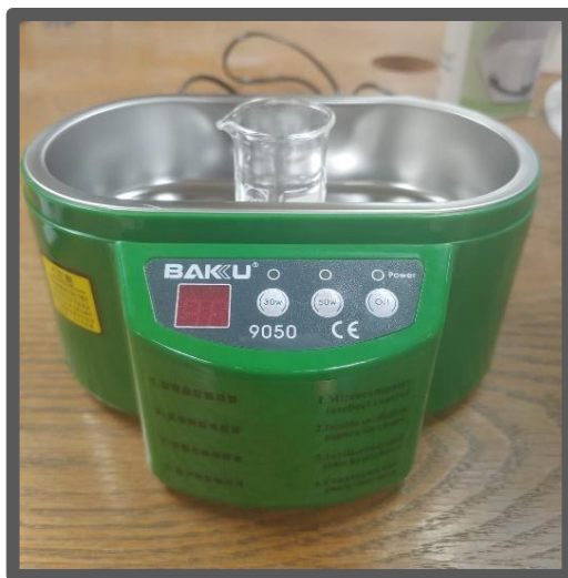
Figura 3.6. Sonicador utilizado para limpieza de sustratos
