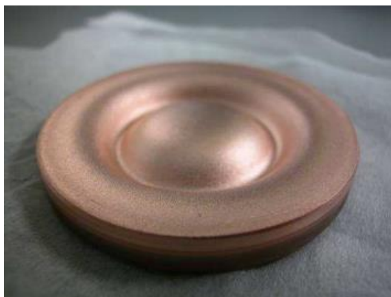
Figura 2.5. Efecto de la “erosión de pista de carrera” [37].
