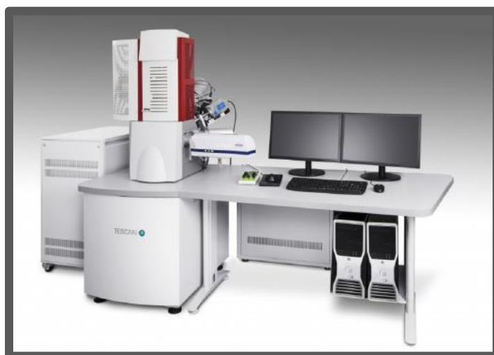
Figura 3.5. Microscopio electrónico de barrido TESCAN LYRA 3.
