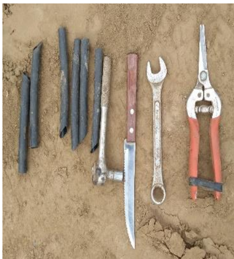
Figura 20. Herramientas del instalador del sistema de riego.
