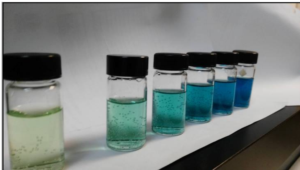
Figura 17. Complejo de formaldehído con MBTH Laboratorio de Análisis de Agua de la FCQI, UABC
