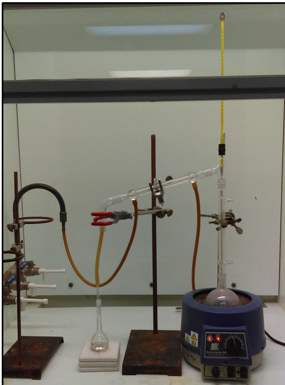
Figura 9. Destilación por arrastre con vapor, Laboratorio de Análisis de Agua de la FCQI, UABC
