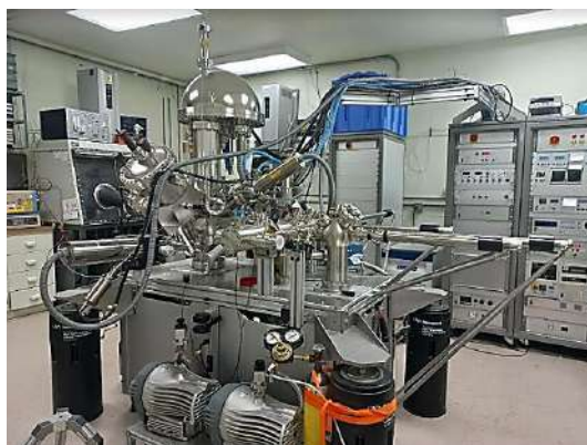
Fig. 18. Espectrómetro de fotoelectrones de rayos X utilizado para la caracterización de los catalizadores.
