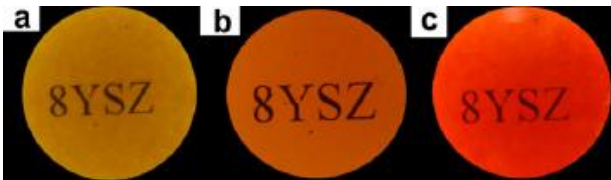
Figura 6. Fotografía de la cerámica 8YSZ sobre texto en una mesa luminosa, las muestras muestran variación en su color y cada una fue sometida a diferentes tiempos de procesado: (a) 10 min; (b) 11 min; (c) 12 min (Casolco et al. 2008).
