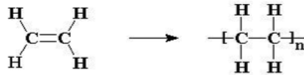
Figura 10. Síntesis de polietileno a partir de etileno por polimerización por crecimiento en cadena-poliadición (Odian, 2004).
