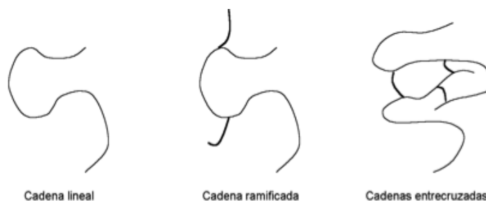
Figura 5. Representación esquemática de los diferentes ordenamientos en las cadenas de polímeros lineales, ramificados y entrecruzados.
