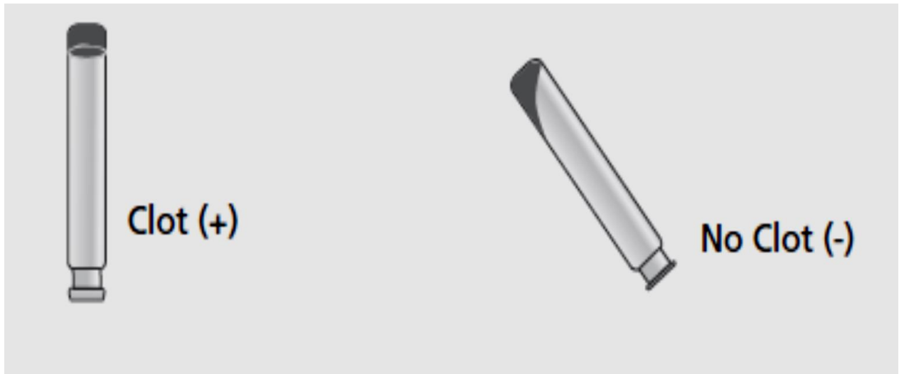
Fig. 16 Presencia o ausencia de coágulo en prueba Pyrosate
