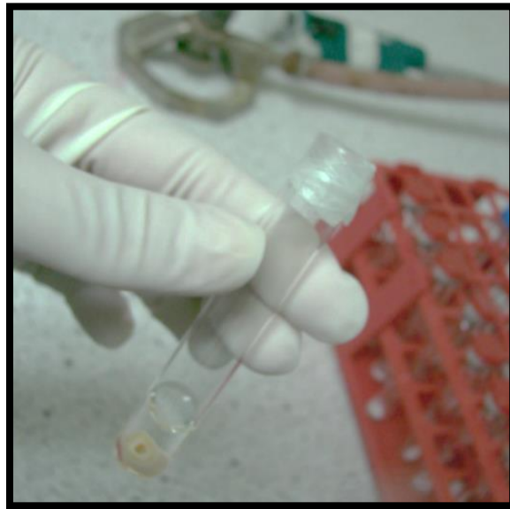
Fig. 13 Tubo de borosilicato Pyrotube sellado con Parafilm.
