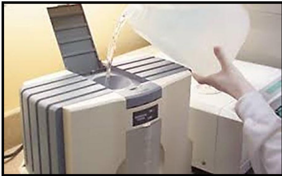
Fig. 3 Generador Optident –Puricore, empleado en el uso de soluciones electroquímicamente activadas
