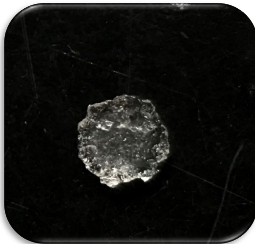
Figura 19. Apariencia del hidrogel después de 48 horas de estudio a pH 1.2.
