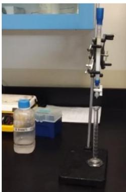
**Figura 7.** Cromatografía de intercambio iónico en una columna Q-sepharose®.
